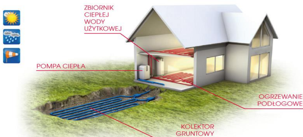
Rysunek 21 Schemat instalacji pompy ciepła w domu jednorodzinnym ( www.archon.pl )
